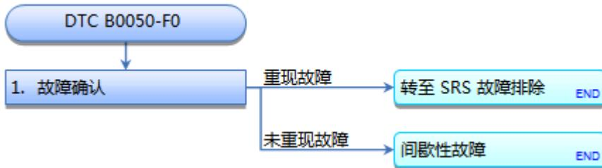
**DTC B0050-F0:** 驾驶员座椅安全带锁扣开关故障
